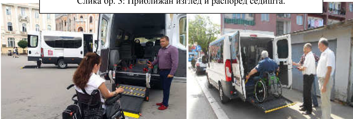
Слика бр. 4 и 5: Приближан изглед механичка рампа за навоз инвалидских колица на задњим вратима
