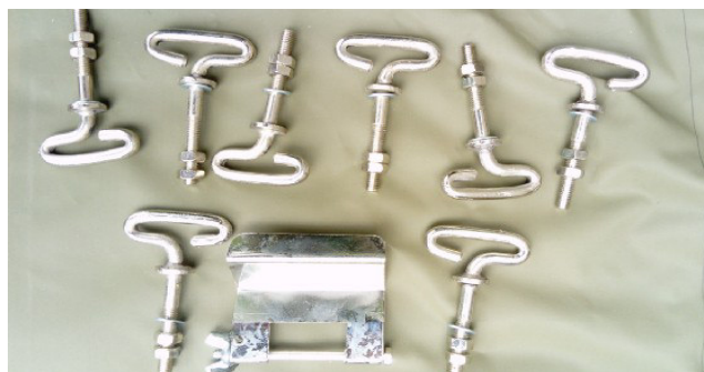
Слика 9 Причвршћивачи бочни (8 ком.) и задњи (1. ком)
