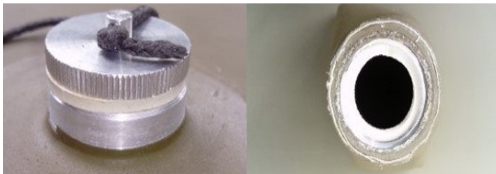
Слика 8 Чаура са чепом (лево) и основа левка за уливање водом (десно)
