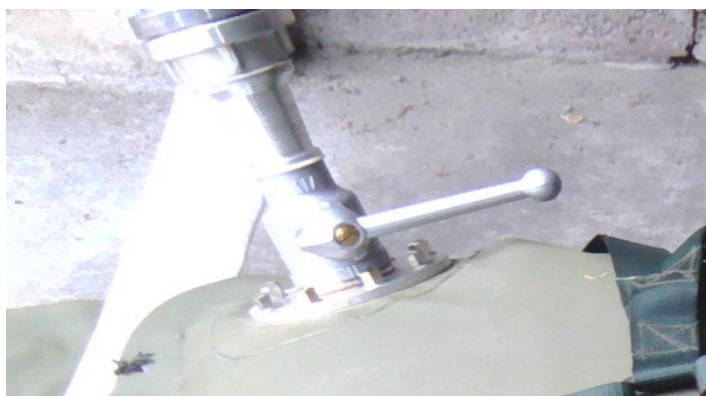
Слика 3 Проточни вентил постављен на резервоар за воду
