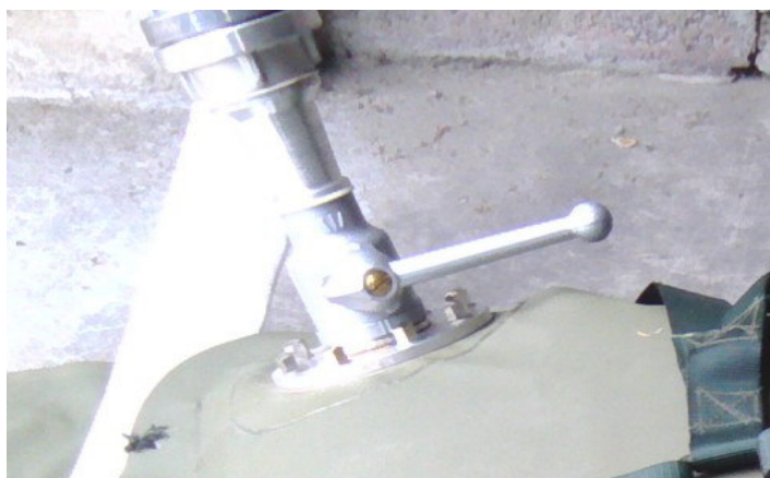
Слика 3 Проточни вентил постављен на резервоар
