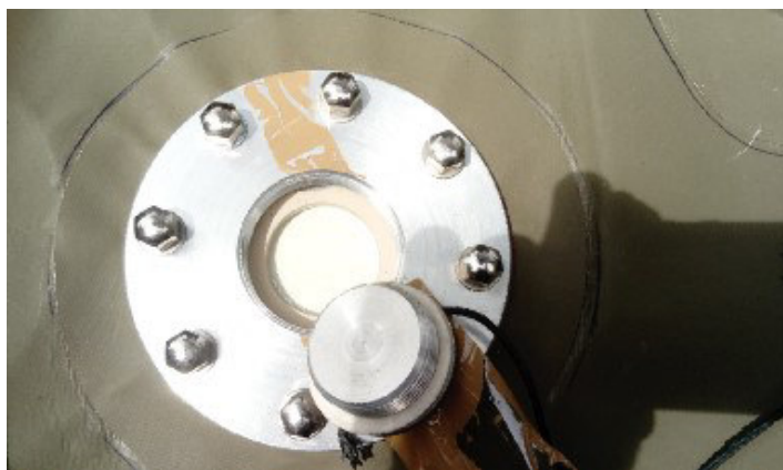
Слика 2 Отвор за пуњење и пражњење резервоара
