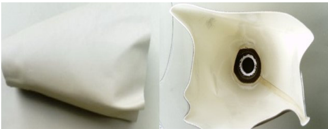
Слика 16 Спољашњи и унутрашњи изглед левка за уливање воде
