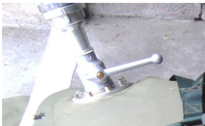
Слика 26 Проточни вентил постављен на резервоар
