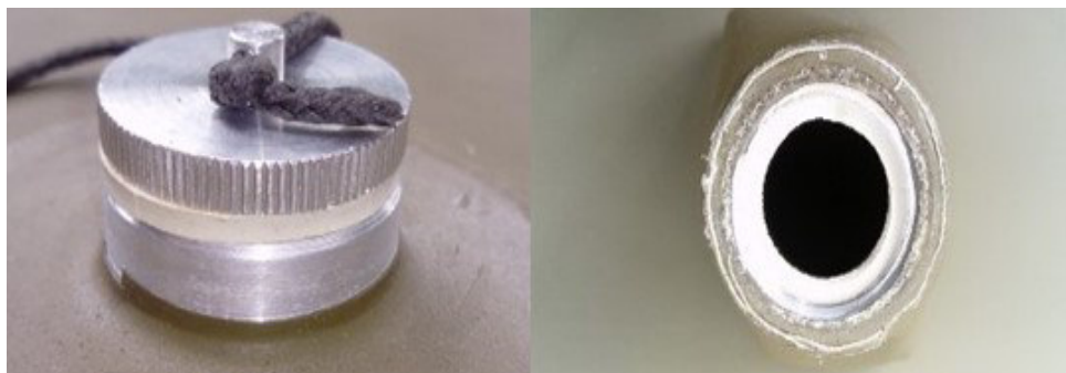
Слика 17 Чаура са чепом (лево) и основа левка за уливање водом (десно)
