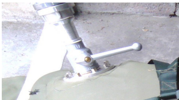
Слика 43 Проточни вентил постављен на резервоар за воду
