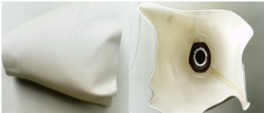
Слика 33 Спољашњи и унутрашњи изглед левка за уливање воде
