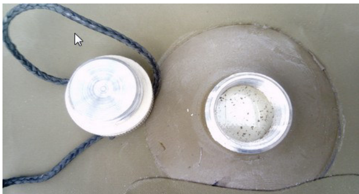
Слика 11 Изглед чауре за уливање воде са чепом
