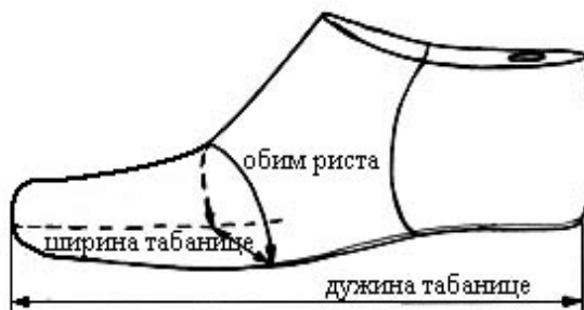
Слика 1 – Основне димензије калупа
