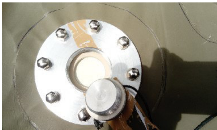
Слика 25 Отвор за пуњење и пражњење резервоара
