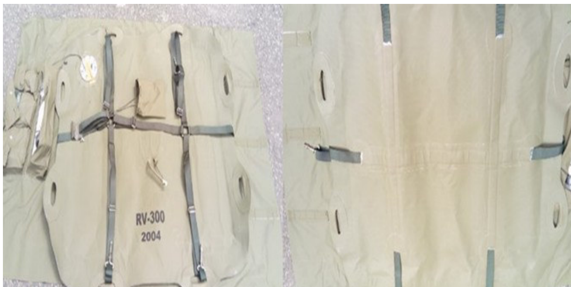
Слика 24 Горња страна (лево) и доња страна резервоара за воду (десно)
