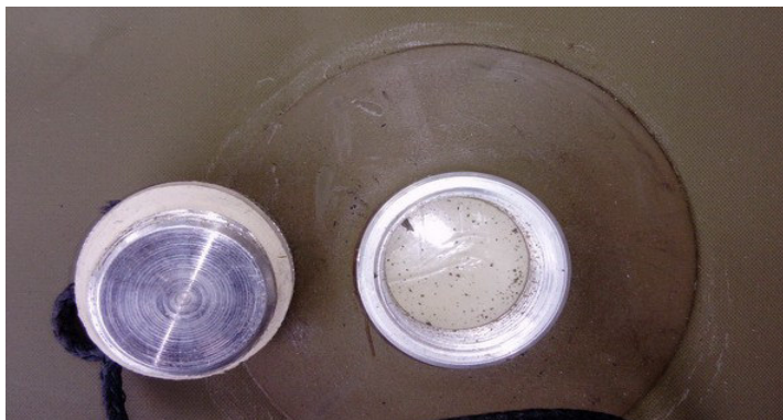
Слика 12 Изглед чауре за пражњење воде са чепом
