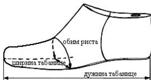
Слика 1 – Основне димензије калупа
