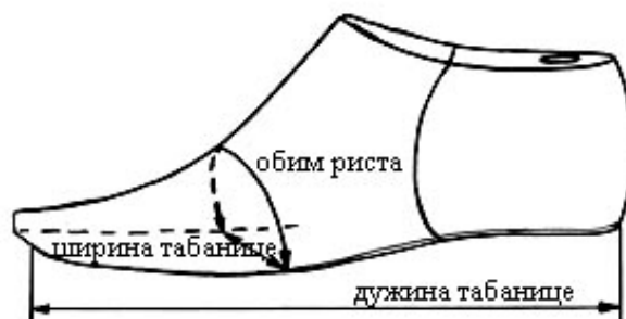
Слика 1 – Основне димензије калупа за ципеле
