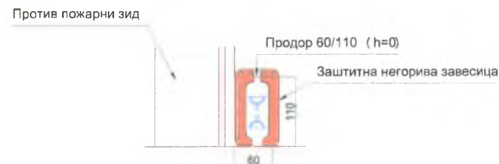
ПОГЛЕД "Б" ( детаљ опшивања продора за једношиноски подни транспортер)
