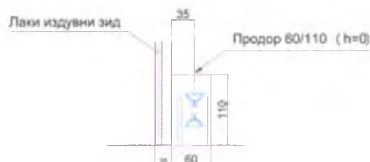
ПОГЛЕД "А" ( детаљ продора једношиноског подног транспортера)
